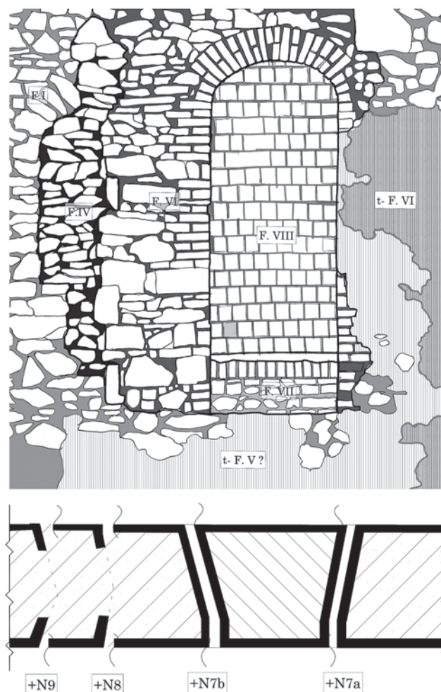
Ilustracja 5-8. Detal węzłów badawczych w ścianie południowej — skrajne prawe okno nawy głównej. Wg I. Krawiec, oprac. I. Krawiec, 2020
